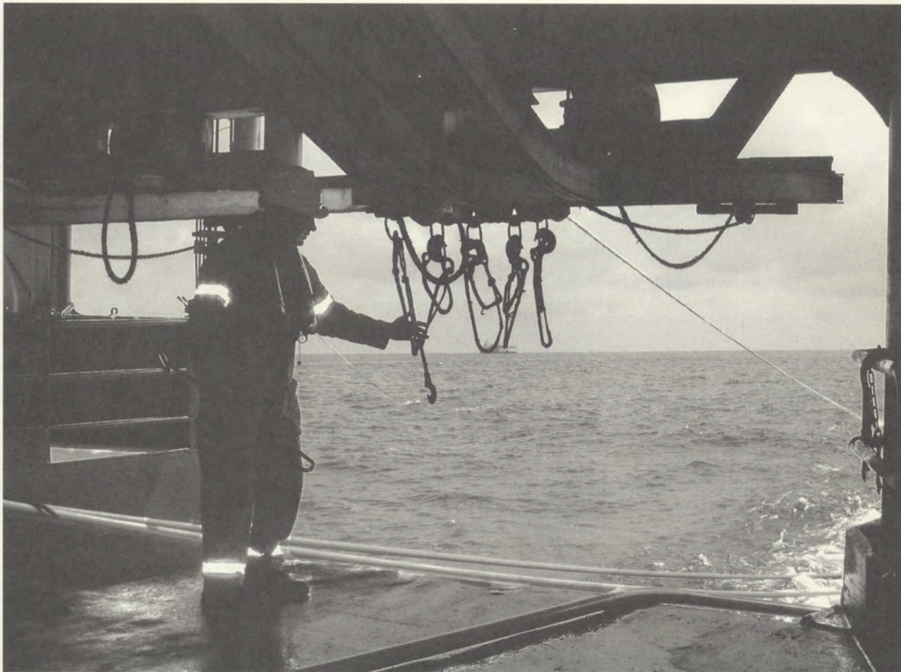
Préparation de la remontée des canons sur le pont arrière du Symphony. / Verification of the trolley rope before recovering arrays, on the Symphony backdeck. (Photo > Brice Buchet)
