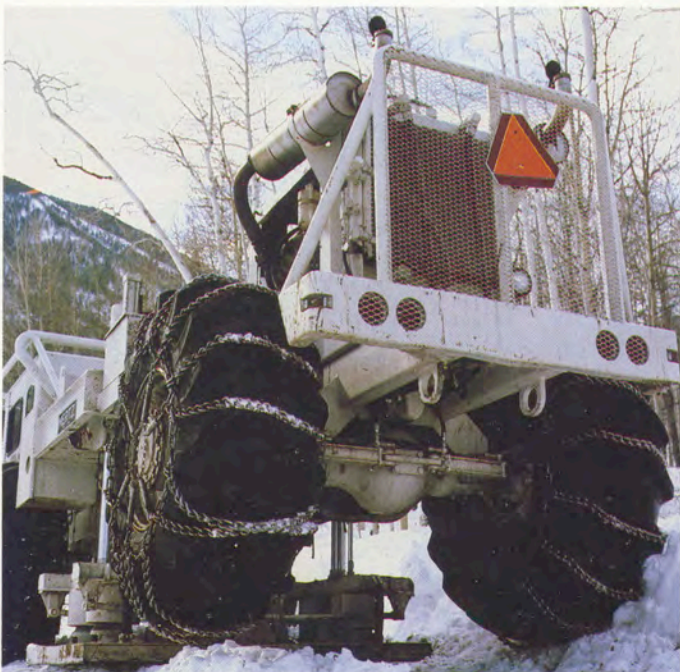
Vibrateur en action (USA). Méthode Vibroseis. * Marque déposée Conoco.
