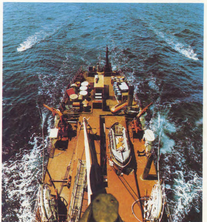
Source large Vaporchoc avec deux canons dérivés.
